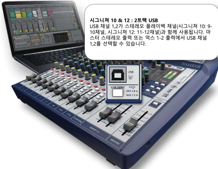
시그니처 10 및 12 콘솔에는 2트랙 USB 입출력 기능이 있습니다. 예를 들어, PC 또는 태블릿에 믹스를 녹음하거나 컴퓨터를 플레이 장치로 사용하는 용도로 쓸 수 있습니다. USB 채널 1,2는 스테레오 플레이백 채널(시그니처 10: 채널 9,10, 시그니처 12: 채널 11,12)에 의해 입력 됩니다.
